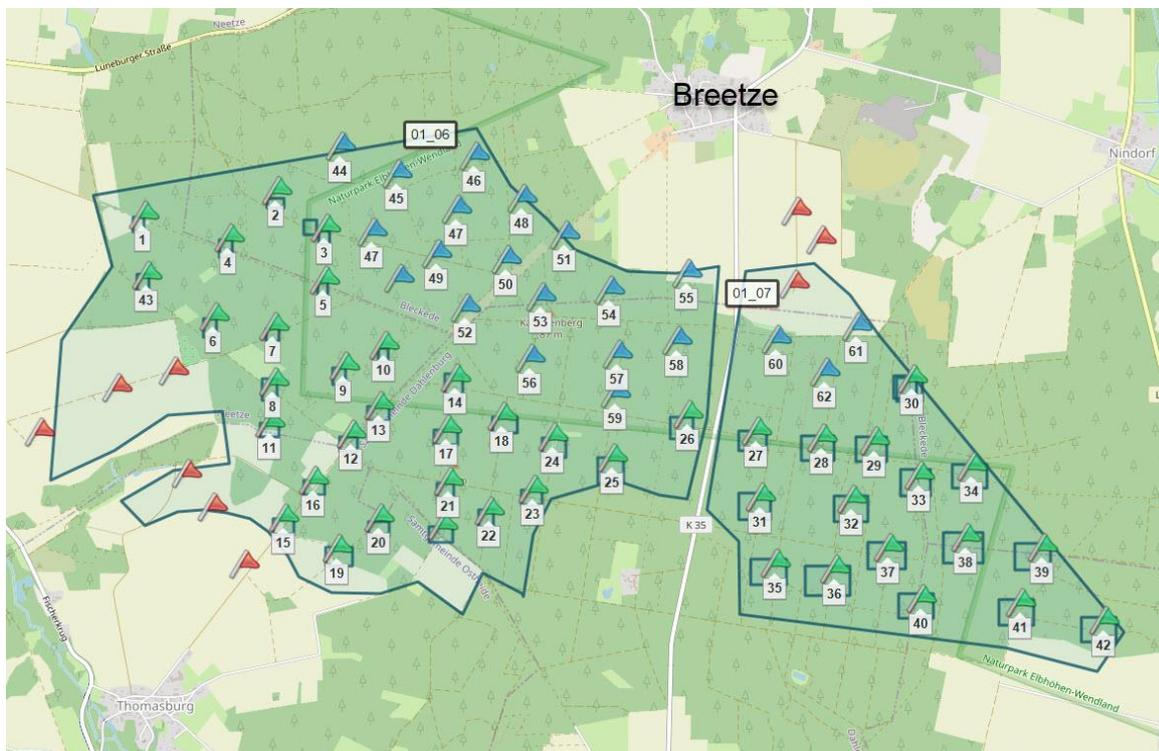
Eingezeichnet sind hier nur 62 Windkraftanlagen. Anhand der Größe der Fläche von über 1000 ha sind rein rechnerisch 100 Windräder möglich (bei einer benötigten Fläche von 10 ha pro Windkraftanlage)
